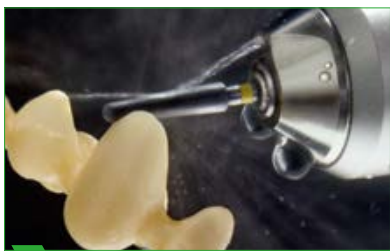
1 Usinage avec turbine sous refroidissement à eau.
