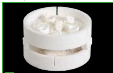
6 Frittage par empilement de restaurations Color/Multicolor.
