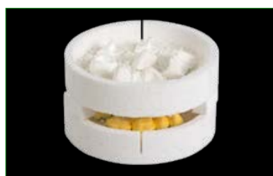
9 Frittage simultané de restaurations préteintées Color/Multicolor et de restaurations teintées manuellement.
