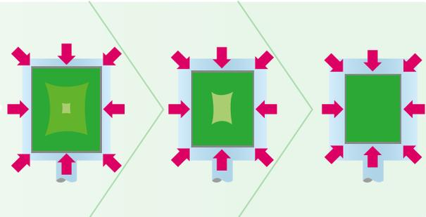
Illustration 3 : schéma du processus de pressée pour les pièces brutes VITA YZ SOLUTIONS
