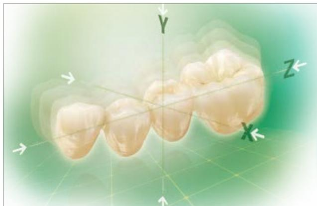
Illustration 4 : schéma type du retrait au frittage (dimensions X, Y, Z)
