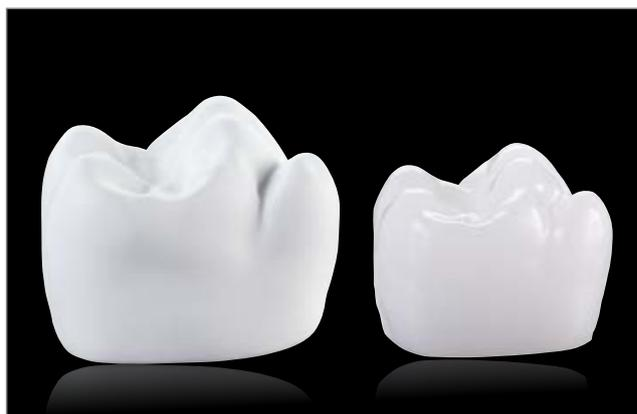
**Illustration 6 :** exemple de retrait au frittage du dioxyde de zirconium d'env. 20 %
