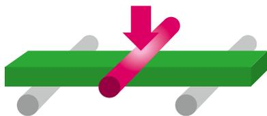
On a utilisé une scie à fil diamanté pour préparer des échantillons parallélépipédiques dans des lingotins en dioxyde de zirconium. Par la suite, les échantillons ont été meulés à la main avec du papier SiC (grain P1200). Ensuite, un chanfrein 45° a été introduit dans les deux bords sur le côté chargé en tension. Après le frittage conformément aux indications du fabricant, les échantillons avaient une dimension finale de 20,0 x 4,0 x 1,2 mm<sup>3</sup>.
